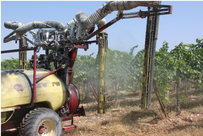
Figura 8. Pulverizador de bajantes Hardy IRIS (actualmente Hardy Optimus T50) tratando en plena
