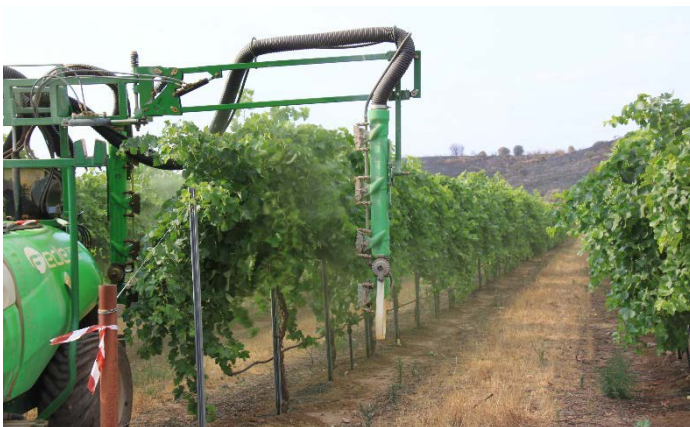
Figura 10. Pulverizador FEDE Tecnovid, incluye cuatro bajantes con cuatro bocas de soplado y dos boquillas por boca.
