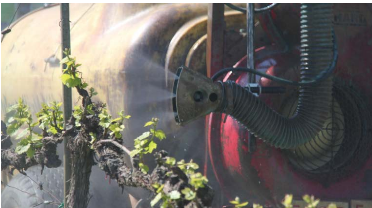
Figura 6. Pulverizador de bocas (multi-salidas). Boca operativa seleccionada para operar a inicio de vegetación en tratamiento de E. carpini en Raïmat.
